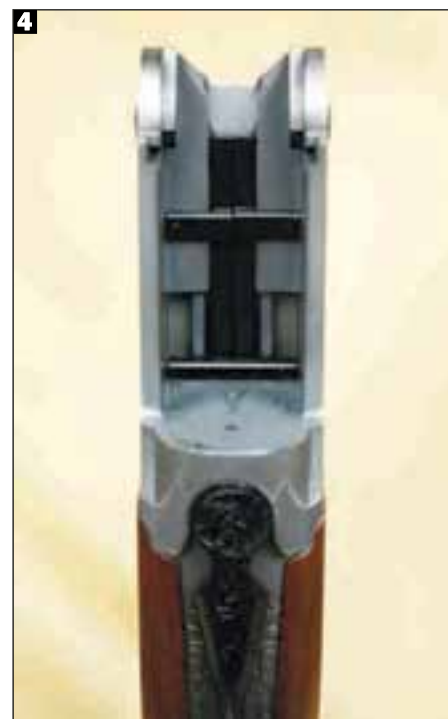
1. La bascula in acciaio, forgiata da massello, è decorata da un'incisione a volute realizzata da Fair con una tecnica laser di ultima generazione chiamata 4D vision, che offre un livello di dettaglio molto elevato, paragonabile a quello dell'esecuzione manuale. 2. Sul petto di bascula, oltre all'incisione floreale, è presente un festone con nome del produttore e modello incisi e dorati. Il ponticello è inciso e brunito nero, realizzato in acciaio. 3. La chiave di apertura è incisa, con palmetta traforata, mentre la coda di bascula ospita la classica sicura a due posizioni, dotata anche di selettore della prima canna. 4. La chiusura è garantita dal classico tassello basso trasversale, che impegna i due ramponi ricavati alla base del monoblocco.
