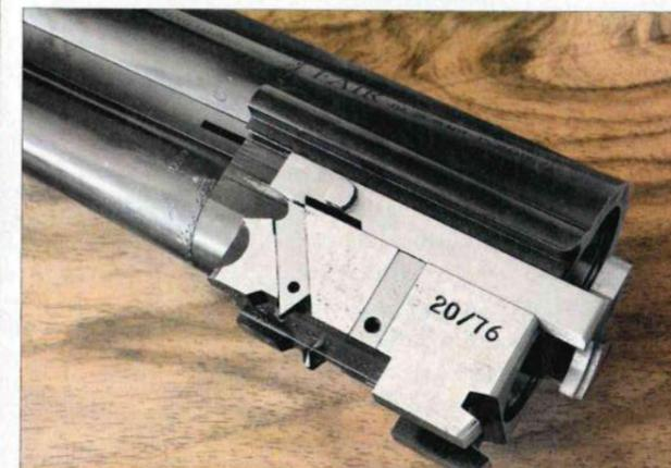
Il calibro e la lunghezza della camera di scoppio sono chiaramente stampigliati sul monobloc; in evidenza i ramponi che concorrono (non passando il fondo di bascula) a determinare la chiusura così detta "gardonese", di concerto con il tassello della bascula
