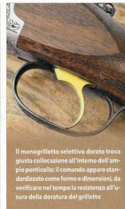
Il monogrilletto selettivo dorato trova giusta collocazione all'interno dell'ampio ponticello; il comando appare standardizzato come forme e dimensioni, da verificare nel tempo la resistenza all'usura della doratura del grilletto
