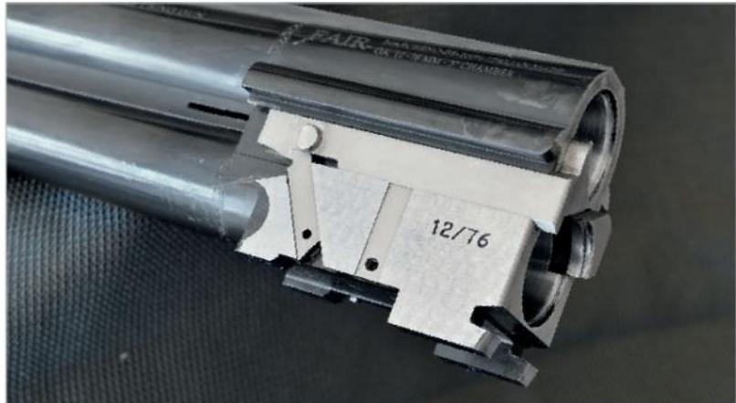
Le canne, camerate magnum e testate steel shot, sono innestate su un monobloc finito a bastoncino; nella foto sono visibili i due ramponi (non passanti il fondo di bascula) su cui si va ad impegnare il tassello di chiusura. Di generose dimensioni i gambi degli estrattori automatici
