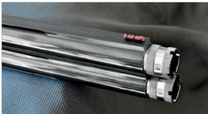
Le canne sono dotate di strozzatori intercambiabili, e nella fattispecie i Technichoke Xp70, del tipo interni/esterni. Bella la loro realizzazione e, una volta montati, completano degnamente l'estetica dello Srl 802 Sporting. La bindella superiore, larga 11 mm e rabescata antiriflesso, possiede una linea centrale denominata "strada" che facilita la collimazione dell'occhio del tiratore con il mirino (in fibra ottica di colore rosso della Lpa) e con il bersaglio
